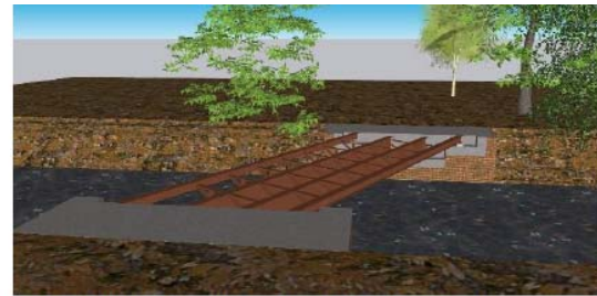
6 – Construction des appareils d'appui Pose de la passerelle sur appuis définitifs
