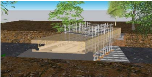
5 – Pose de la passerelle sur des cales provisoires, confinement étanche plomb Dépose des garde-corps existants, sablage, soudure des goujons, application d'un système de peintures multicouche
