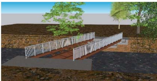
7 – Pose des garde-corps métalliques S8 Raccordements hors ouvrage
