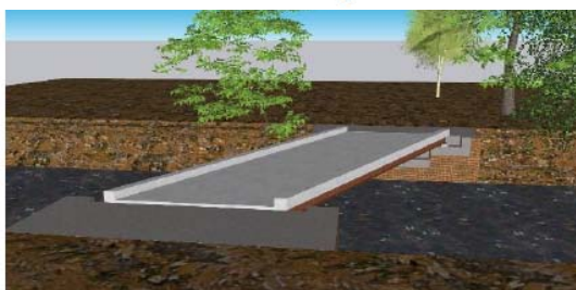
7' – Pose des sections préfabriquées BA Scelllements et clavetages
